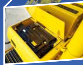
WECHSELRICHTER UND KONDENSATOR
