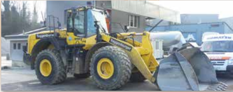
WA470-8 mit Schnellwechsler im Einsatz im Kieswerk Aadorf
