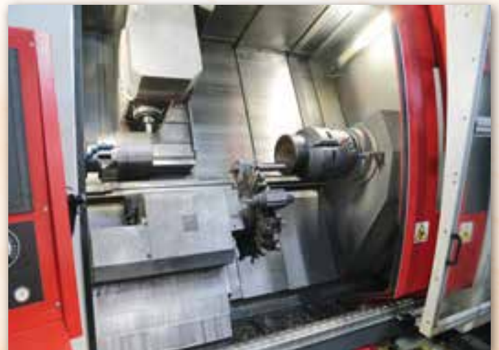
Der großzügige Arbeitsraum ist leicht zugänglich. Der Abstand von 1.700 mm zwischen den Spindelnasen erlaubt eine Simultanbearbeitung von zwei Teilen.
