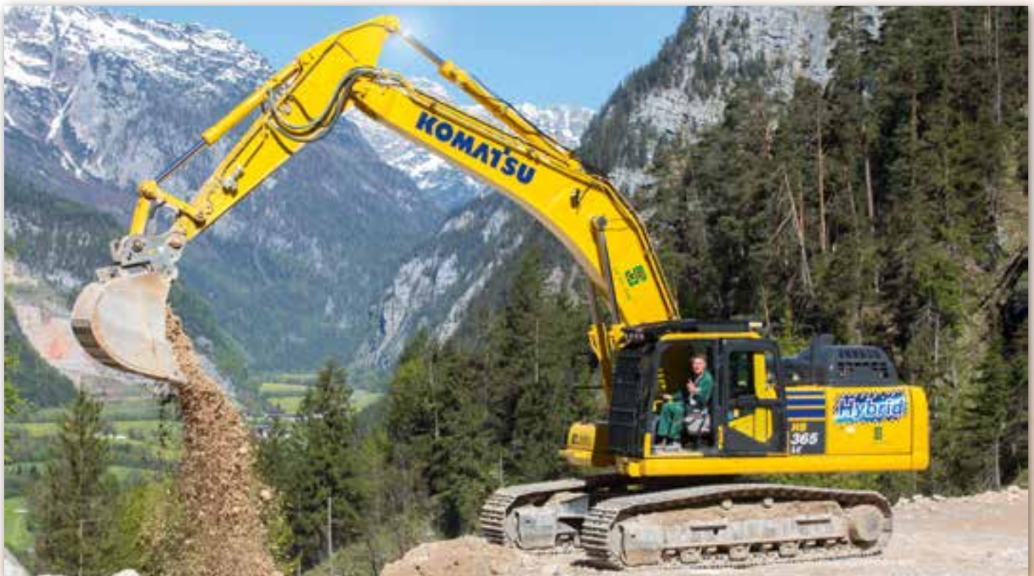
Das Gerät arbeitet mit einem elektrischen Hybridsystem. Der Hydraulikbagger speichert Energie beim Abbremsen der Schwenkbewegung des Oberwagens in einem Superkondensator neben dem Ausleger.
