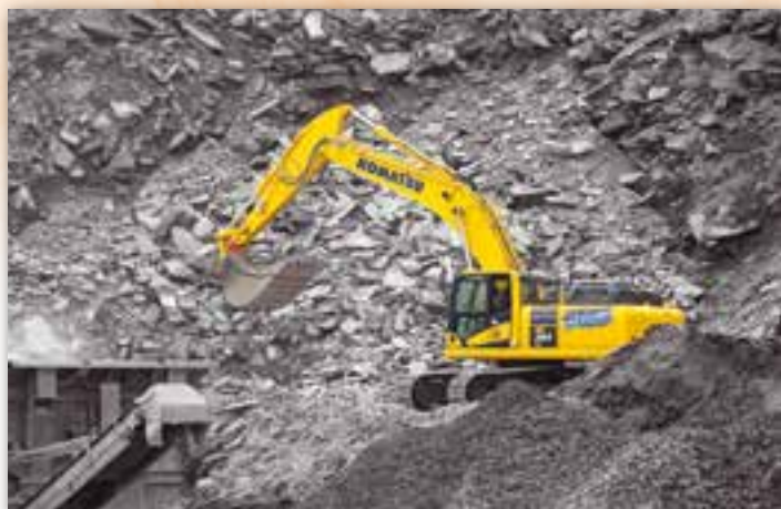
Komatsu Bagger HB365LC-3 mit Hybridantrieb, 36 t Betriebsgewicht
