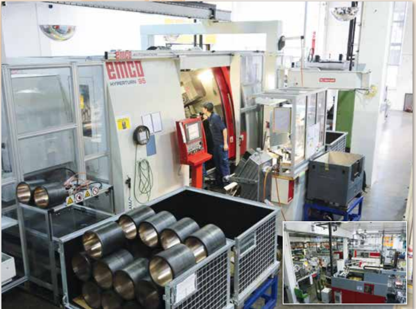
Emco Hyperturn 95 für die Bearbeitung von Werkstücken bis \varnothing 400 mm in der Abteilung Gleitlager und Anlaufringe bei Miba
