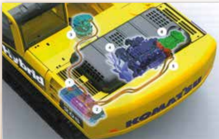
Komatsu-Hybridssystem: 1 – Kondensator, 2 – Umrichter, 3 – elektrischer Schwenkmotor/Schwenkgenerator, 4 – Verbrennungsmotor, 5 – Generator/Motor, 6 – Hauptpumpe
