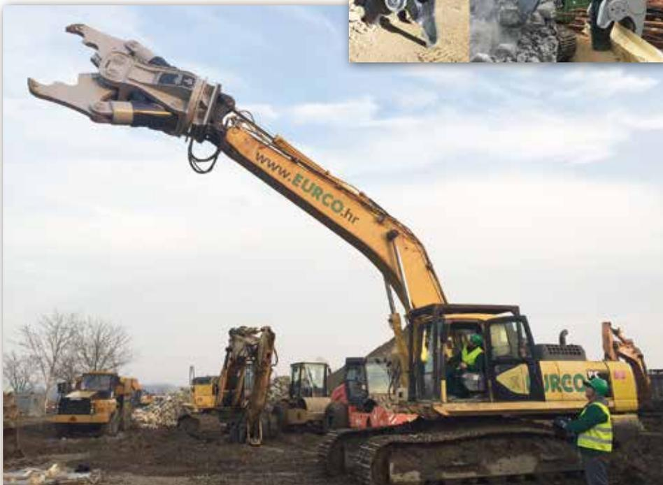
Komatsu PC450 (ca. 50 to) ausgestattet mit einer Abbruchzange VX100ER für den optimalen Einsatz bei Abbrucharbeiten
