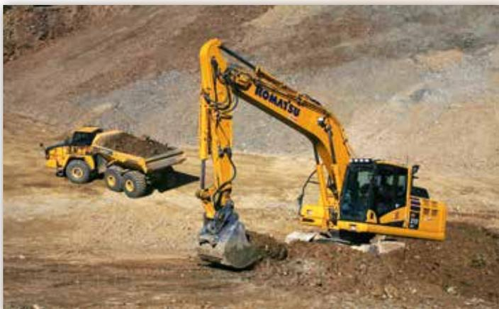
Die naturnahe Gestaltung erfordert Einschnitte in verschiedenen Höhen. Die richtige Aufgabe für den Komatsu PC210LCi, der bereits ab Werk über die „intelligent Machine Control“ verfügt und zielgenau die festgelegte Fläche oder Tiefe nicht überschreitet.
