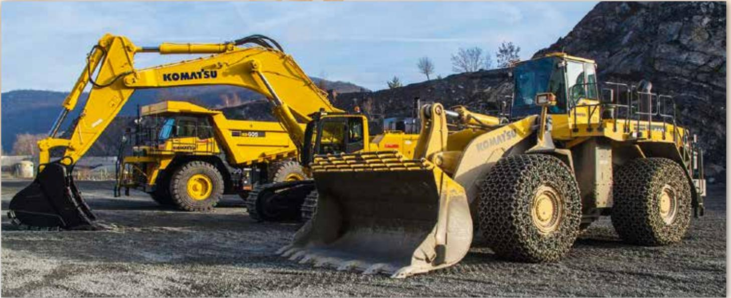
Der übergebene Muldenkipper Typ HD605-7, der Hydraulikbagger Typ PC800-8 und der schon früher gelieferte Radlader Typ WA600
